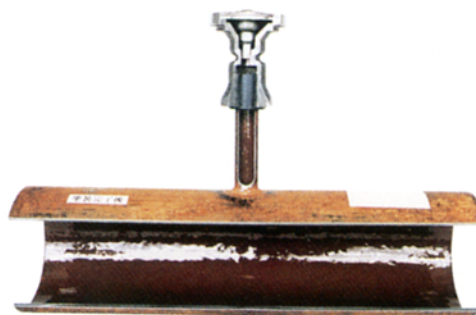
〈クリーンエポで甦った消雪管の断面図〉
